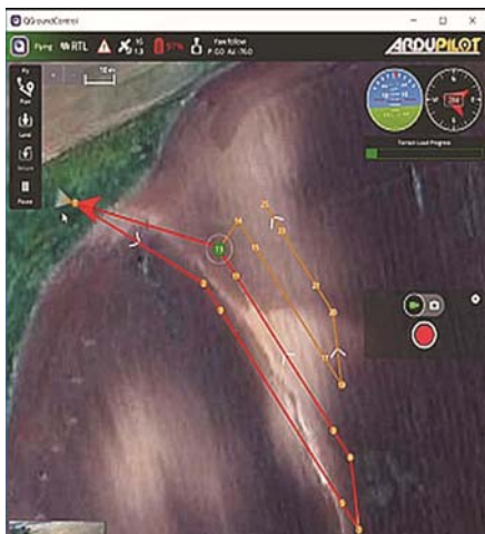
Рисунок 3.1 – Обнаружение нефтяных пятен с БПЛА: цветное изображение, характеризующее маршрут полёта над чернозёмом и зелёными насаждениями (а); изображение вегетационного индекса, рассчитываемого по двум спектральным каналам, с выявленными участками загрязнений (б)
