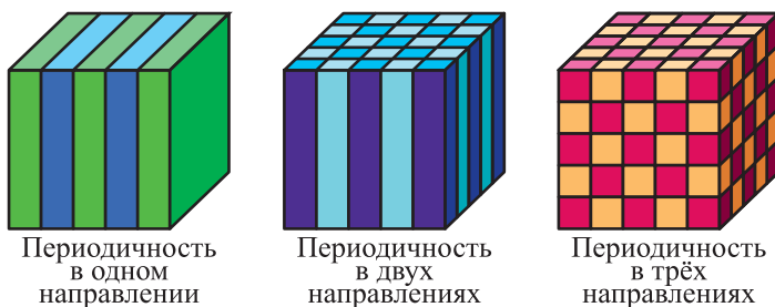
Рисунок 4.11 – Одно-, дву- и трёхмерные фотонные кристаллы
