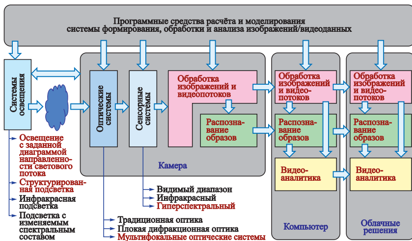
Рисунок 3.5 – Архитектура цифровой платформы киберфотоники
