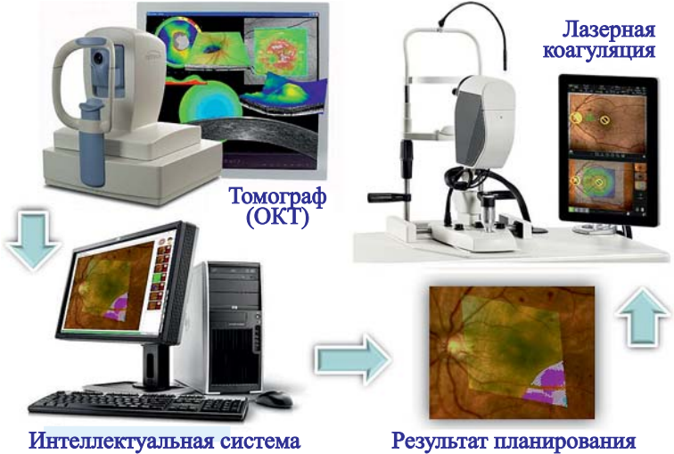
Рисунок 3.8 – Интеллектуальная система поддержки принятия решений по персонализации лазерного лечения сетчатки
