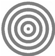
Рис. 1. Структура бинарного дифракционного аксикона
