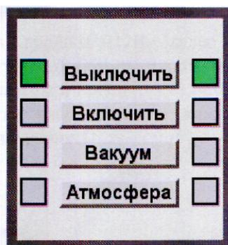
Рис.5.3.3 Панель управления установкой и вакуумной системой. Кнопки разблокированы.
