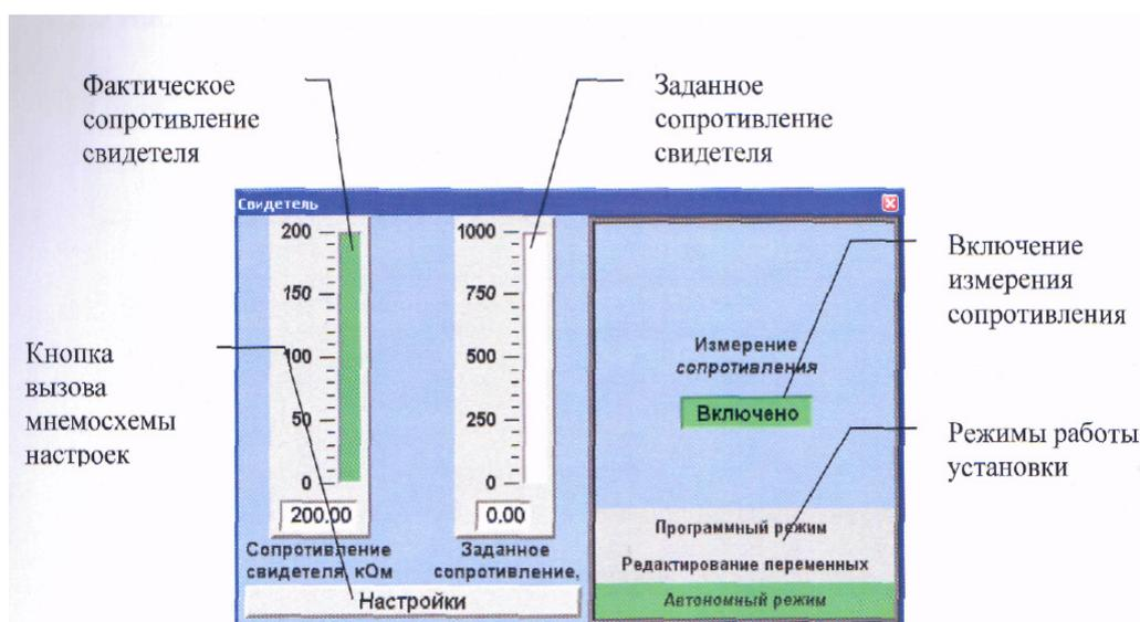
**Рис.5.3.13** Мнемосхема свидетеля.
