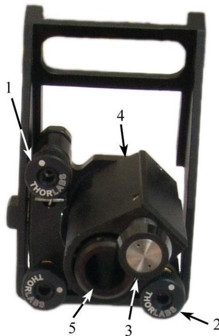
Fig. 2-14. Side illumination module
