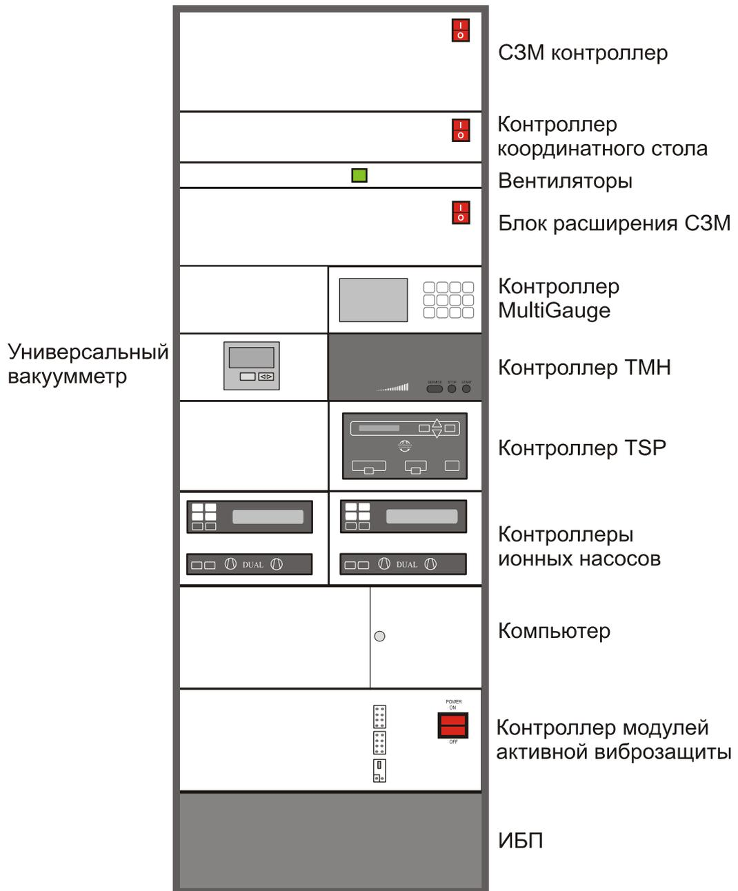
Рис. 2-22. Шкаф электроники модуля UHV SPM
