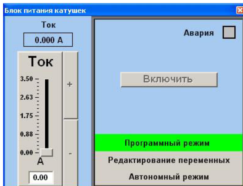
Рис. 6.19 Окно управления блоком питания катушек.
