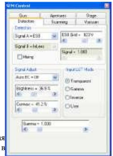
возникнуть яркое пятно. В этом случае, диафрагма встроенного в линзу детектора ухудшает изображение. Чтобы избежать этого, для получения изображения общего вида всегда используют детектор Se2, например, при сканировании образца или при работе на очень больших рабочих расстояниях.
